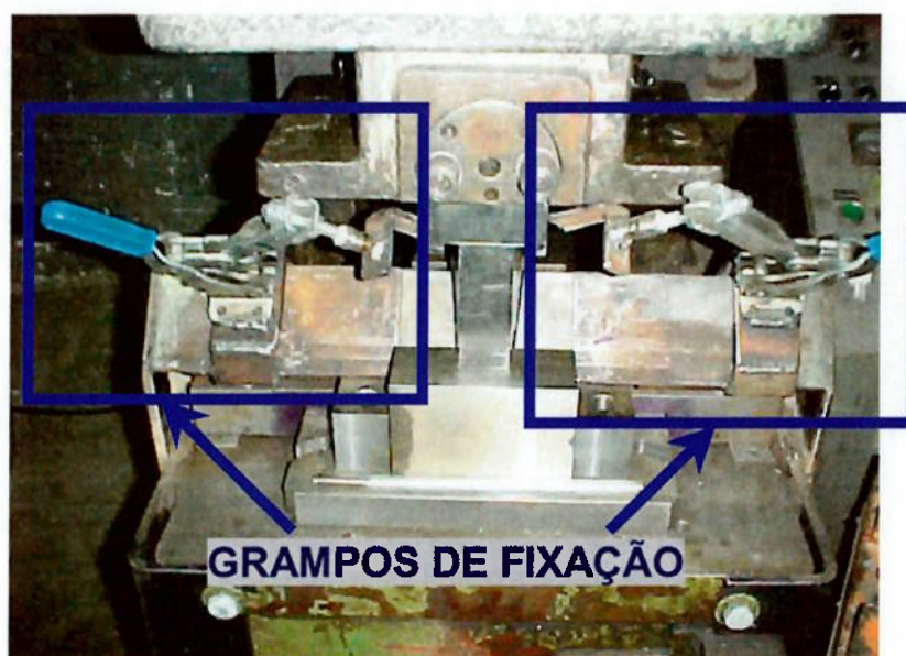
Figura 32 - Ferramenta de Corte e Dispositivos de Fixação
