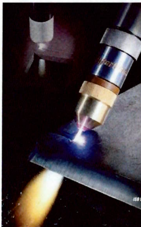
Figura 12 - Corte plasma em chapa de aço
