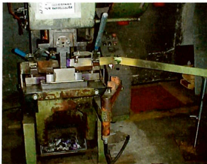
Figura 31 - Ferramenta de Corte instalada na Prensa
